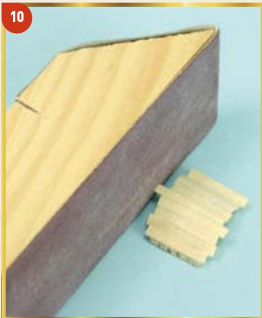
**10** С помощью шлифовального блока обработайте концы приклеенных планок так, чтобы они не выступали за края козырька.
