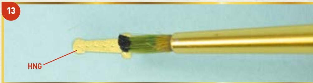
**13** Извлеките четыре дверные петли (детали HNG) из металлической матрицы, которую вы получили с данным выпуском. Обработайте их края надфилем, после чего покрасьте эти детали в черный цвет.
