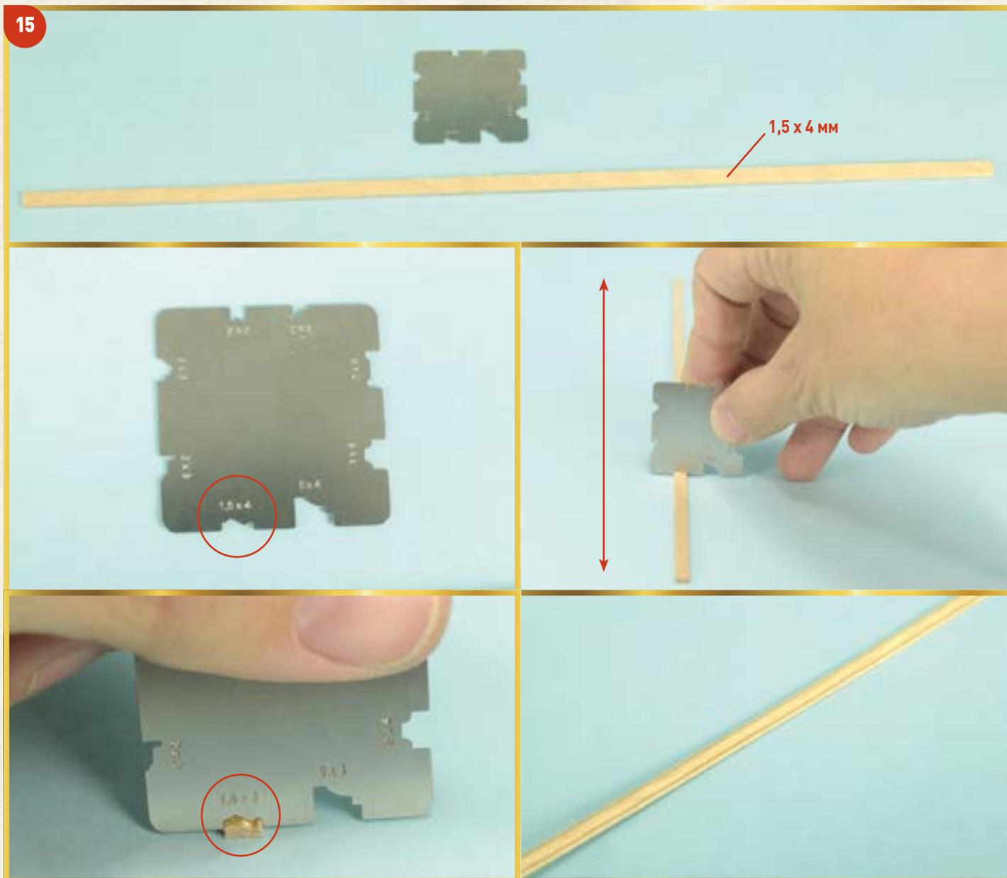
**15** Возьмите планку 1,5 x 4 x 250 мм, которая прилагалась к этому выпуску. Вы можете обработать ее так, чтобы получился декоративный молдинг (данная операция не является обязательной). Выберите на специальной пластине подходящий под размер планки профиль и обработайте пластиной всю планку до получения желаемого результата.
